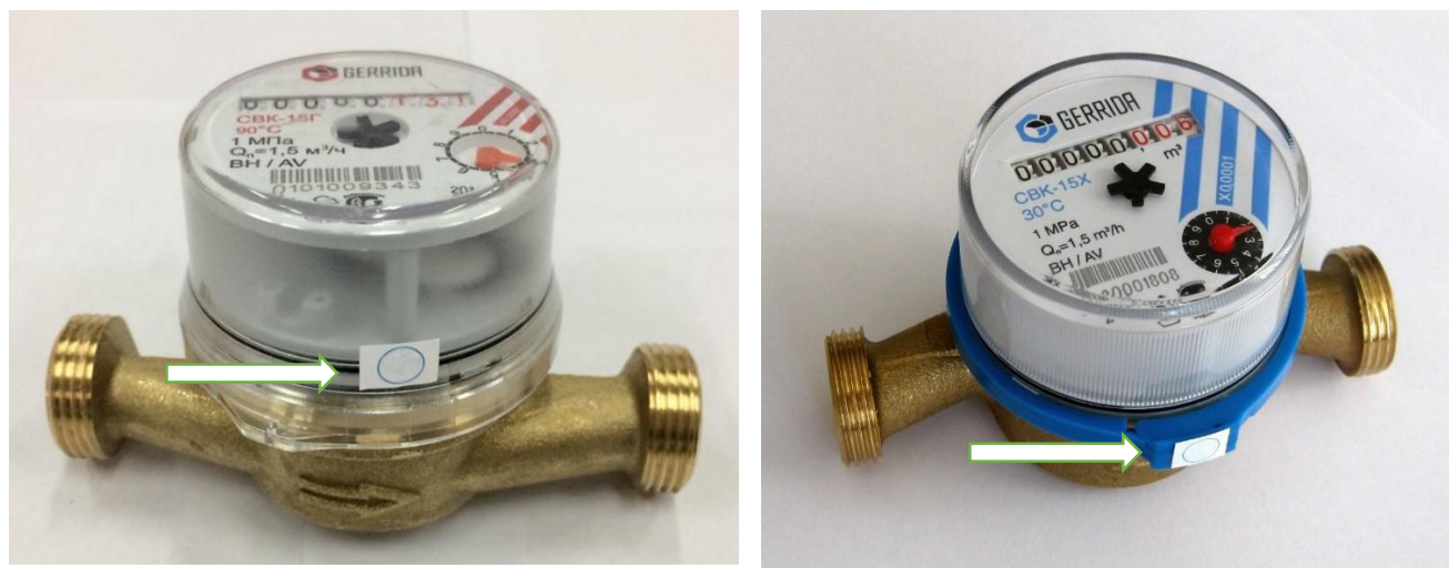
Рисунок 4 – Схема пломбировки от несанкционированного доступа, обозначение места нанесения знака поверки счетчиков воды крыльчатых СВК, СВКМ
